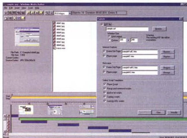
Figura 1- Il Media Producer al momento di provvedere alla pubblicazione del file ASF appena realizzato. Da notare che nel pannello di comando Publish possono essere settate entrambe le funzioni di generazione automatica del codice HTML sia per l'Explorer che per Navigator.
